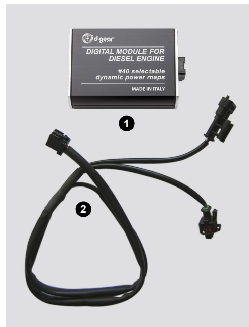
Fig.1 CONTENUTO DEL KIT 1 Centralina modulo aggiuntivo 2 Cablaggio con connettori originali
