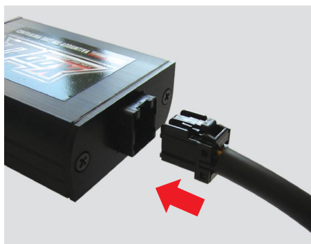
Fig.5 connessione alla centralina tuning box connection
